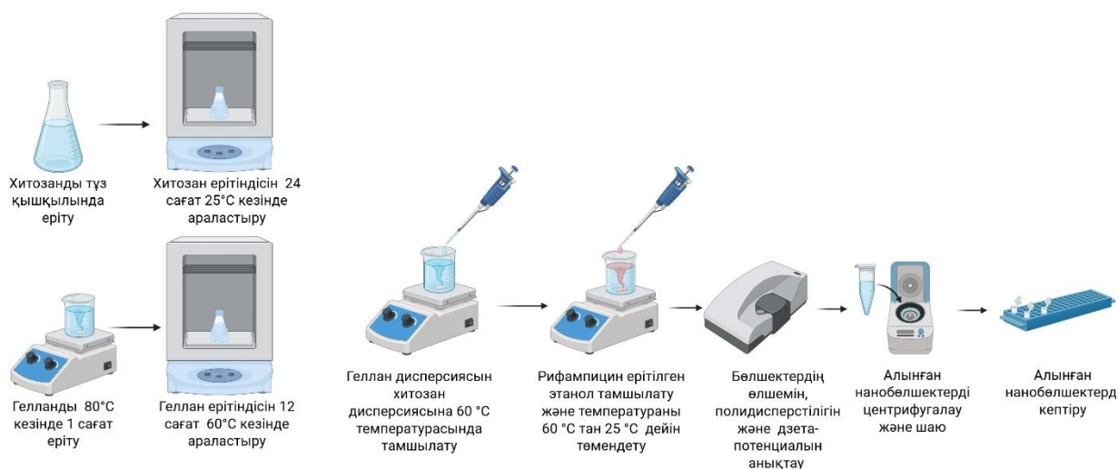
Сурет 1. CS-GG-RIF нанобөлшектерін полиэлектролиттік кешенді коацервация әдісімен алу процесінің сызбасы
